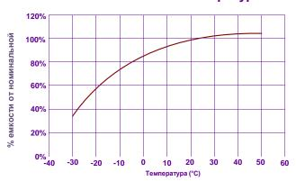
**Емкостно-температурная зависимость:** На графике показано изменение емкости аккумулятора при различной температуре окружающей среды..
