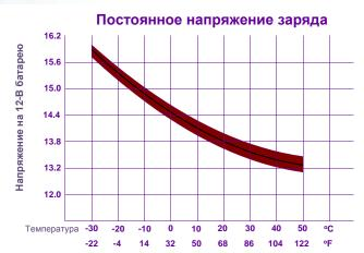
**Постоянное напряжение заряда:** На графике указана зависимость постоянного напряжения заряда от температуры окружающей среды. Напряжение заряда имеет «окно» допустимых отклонений от номинального значения при различных температурах (± 30мВ/эл.)
